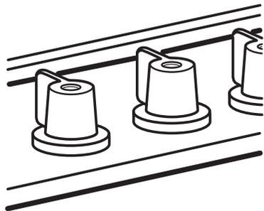
Überprüfen Sie den korrekten Einbau, indem Sie jeden einzelnen Brenner separat zünden.
