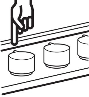
Pişirme yüzeyindeki düğmelerin tümünü yukarı çekin ve çıkardıktan sonra birlikte saklayın.
