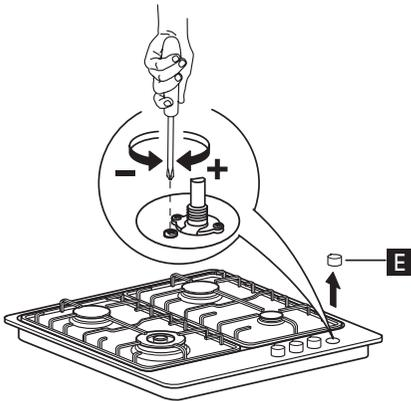
Um sicherzustellen, dass die kleinste Stufe korrekt eingestellt ist, den Knopf (E) abziehen und folgendermaßen vorgehen:
