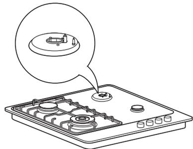
**HINWEIS:** Um Schäden an der Elektrozündung zu vermeiden, betätigen Sie diese nicht, wenn der Brenner zerlegt ist.
