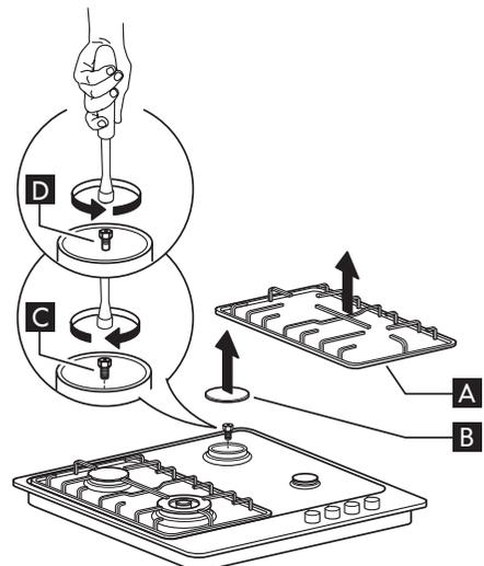
**Einstellung der Minimalstufe der Hähne**
